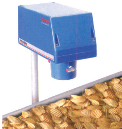
图1 工作中的Spectra-Quad在线成分分析仪
